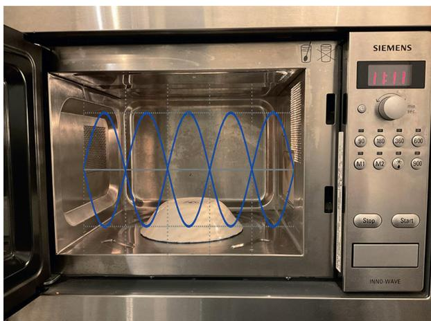
Abb. 6. Beispiel für eine (in diesem Fall in der Küche des Erstautors) stehende Mikrowelle
